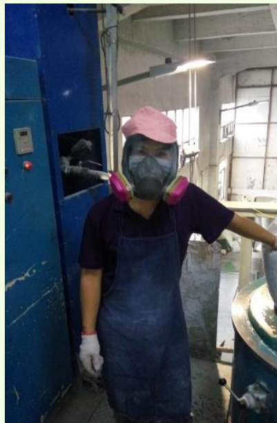
電線配料崗之護目粉塵手部防護
